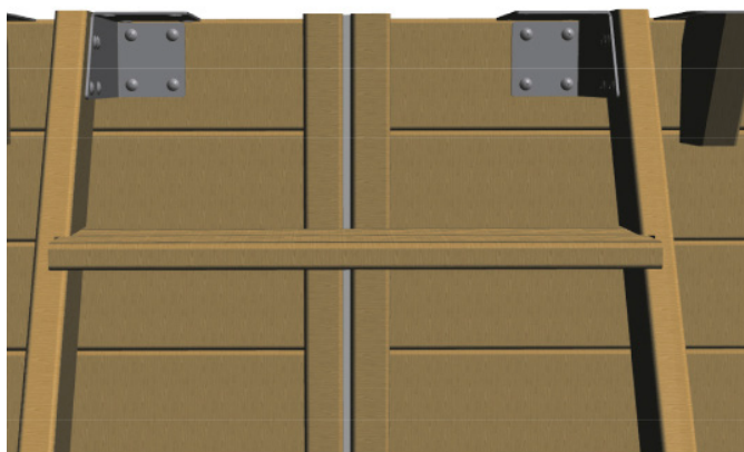
Figura 16 – Fijación de la escalera exterior sobre el vaso
