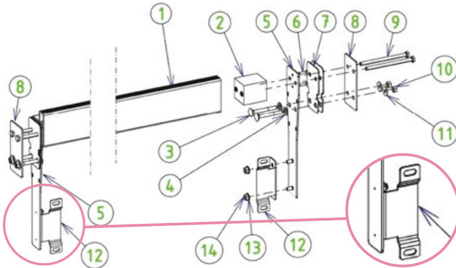
Figura 41 – Ensamblaje y montaje de la vigueta
