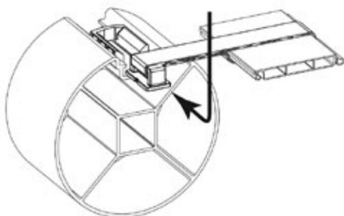
Figura 45 – Unión de la estructura y del eje
