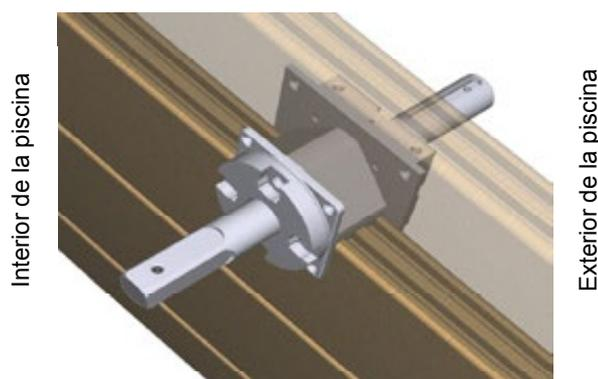
Figura 38 – Montaje del árbol de cubierta automática
