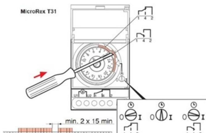
Figura 57 – Programación automática de la filtración
