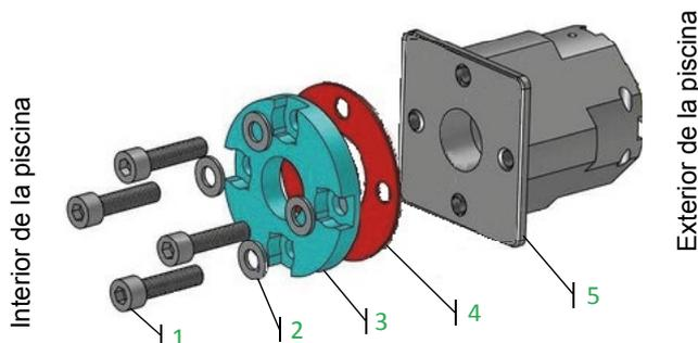
Figura 35 – Montaje de la brida del pasamuros
