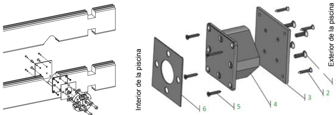
Figura 27 – Montaje del soporte del cojinete
