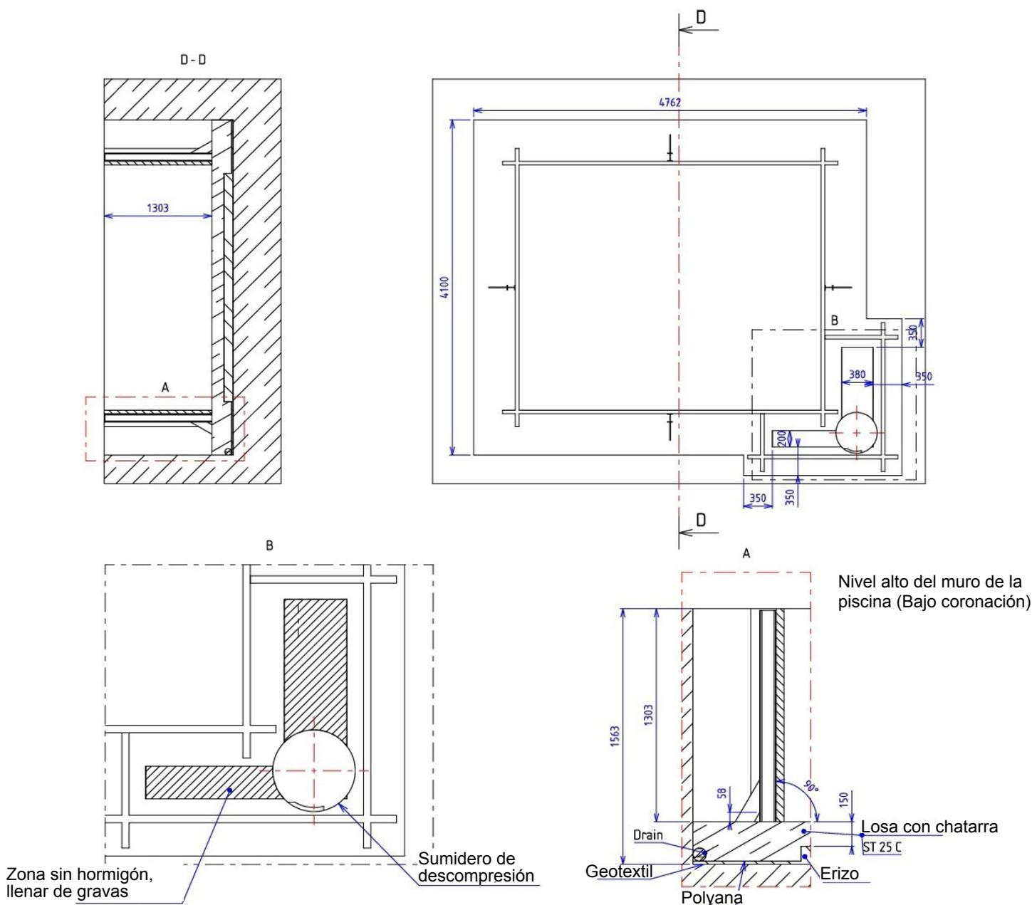
Figura 5 – Características de la losa de hormigón
