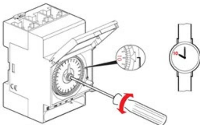
Para establecer los rangos de tiempo de conmutación (los rangos de tiempo durante los cuales la filtración estará en funcionamiento), presione los segmentos correspondientes fuera de la esfera del reloj, como se muestra en la *Figure 57*. Cada segmento representa 15 minutos.
