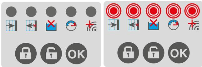
Cuando los 5 LEDs parpadean, presione el botón OK durante 1 segundo. Los dos LEDs de la izquierda se iluminan.
