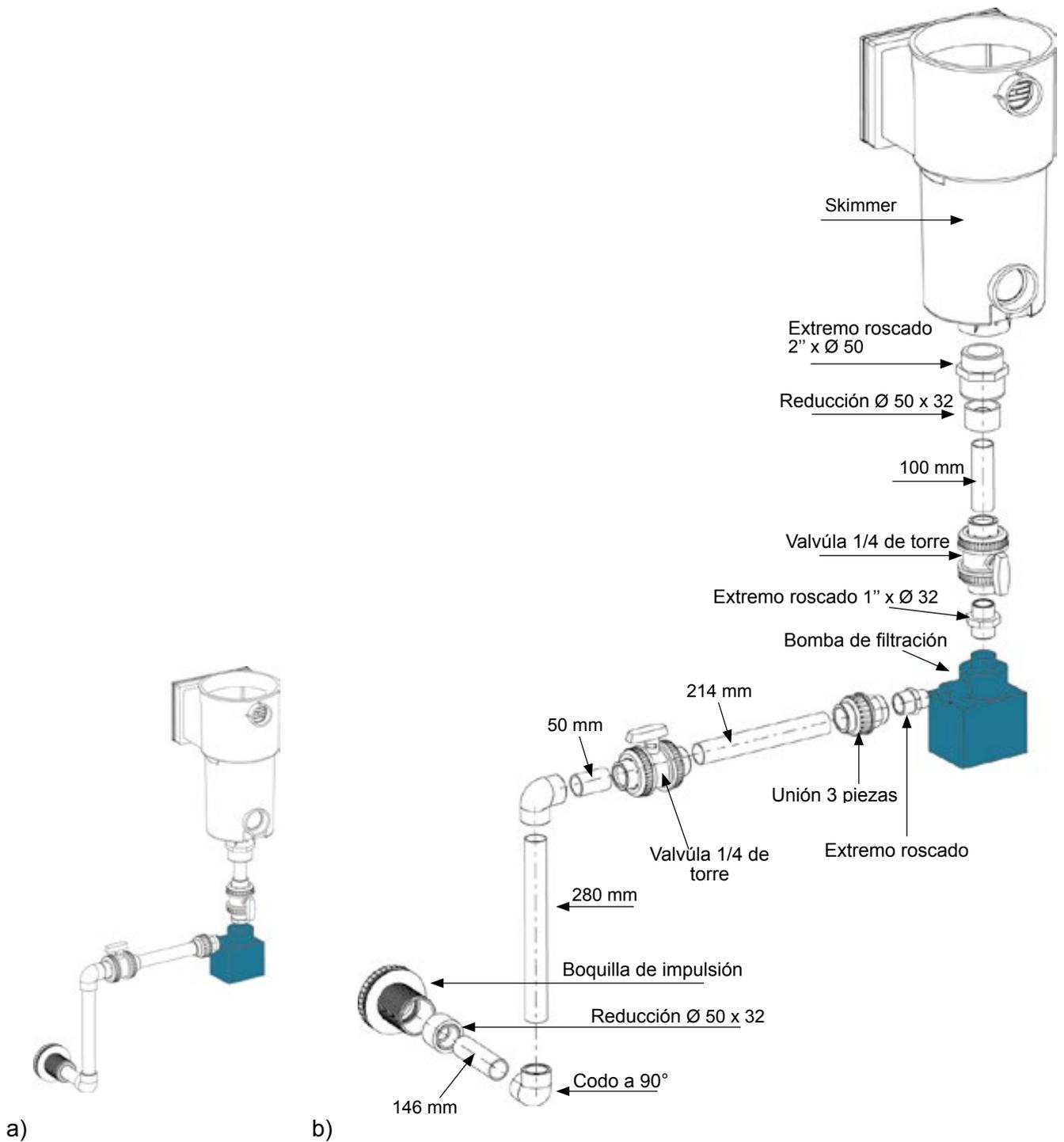
Figura 24 – a y b Tubería para la filtración
