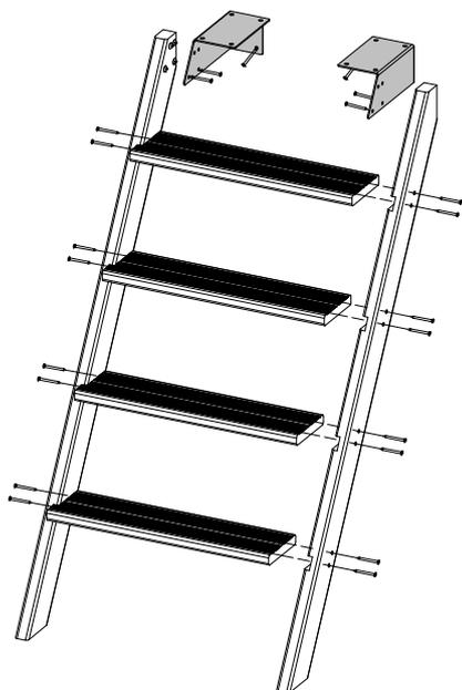
Figura 15 – Montaje de la escalera exterior de madera
