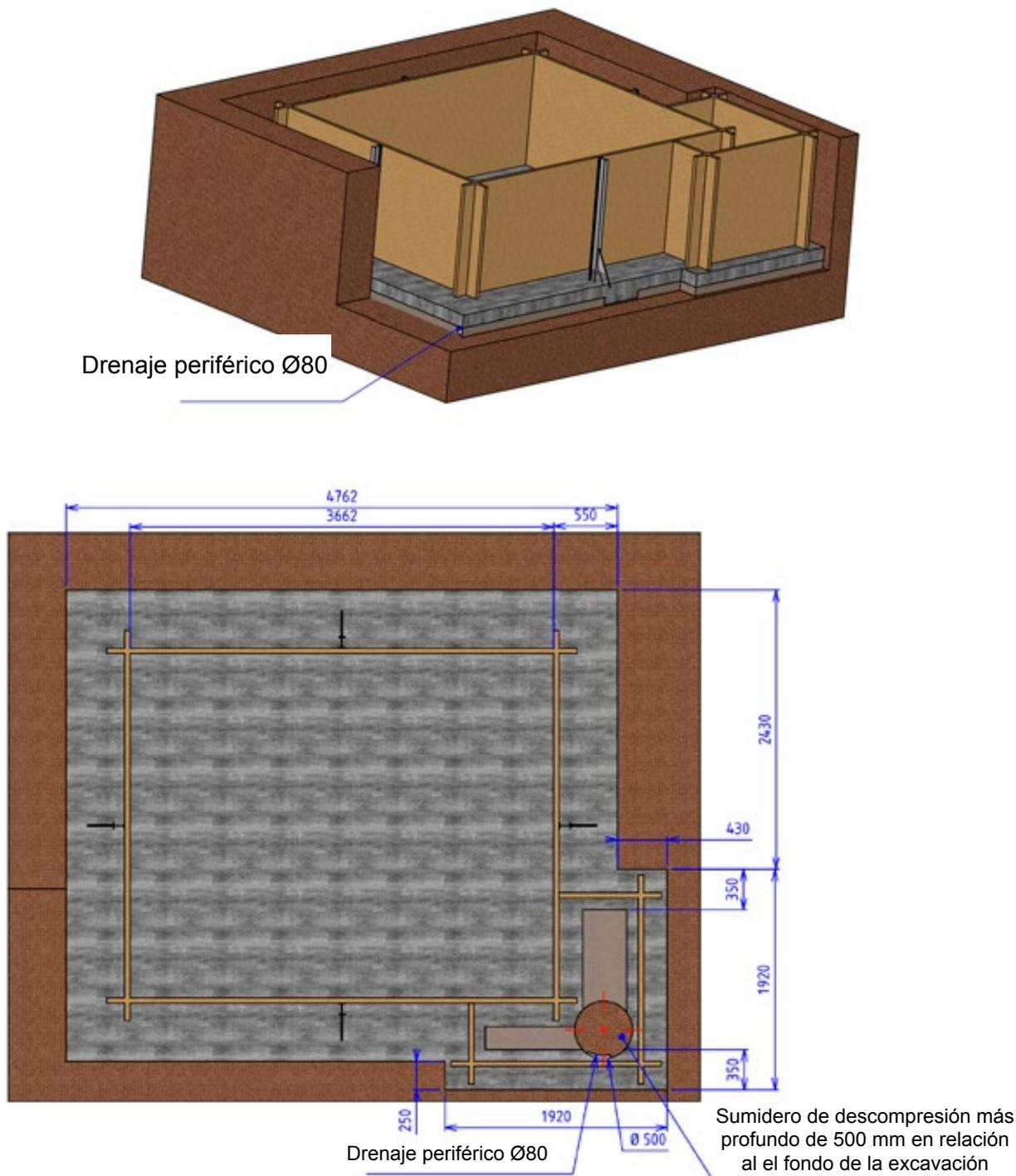
Figura 1 – Disposición del sistema de drenaje
