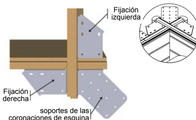
Figura 18 – Colocación de herrajes en esquinas
