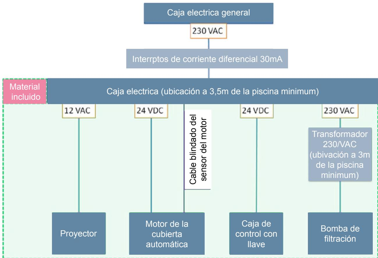
Figura 54 – Esquema de la instalación eléctrica de la PISCINA URBANA
