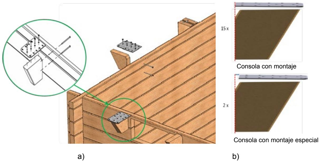
Figura 13 – a y b - Montaje de placas de metal sobre las consolas de las coronaciones
