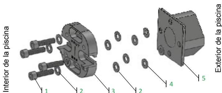
Figura 36 – Montaje de la brida porta-cojinete
