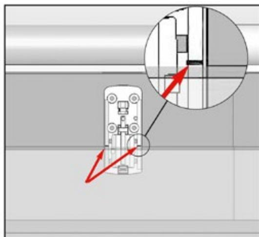
Figura 46 – Instalación de enganches de la estructura
