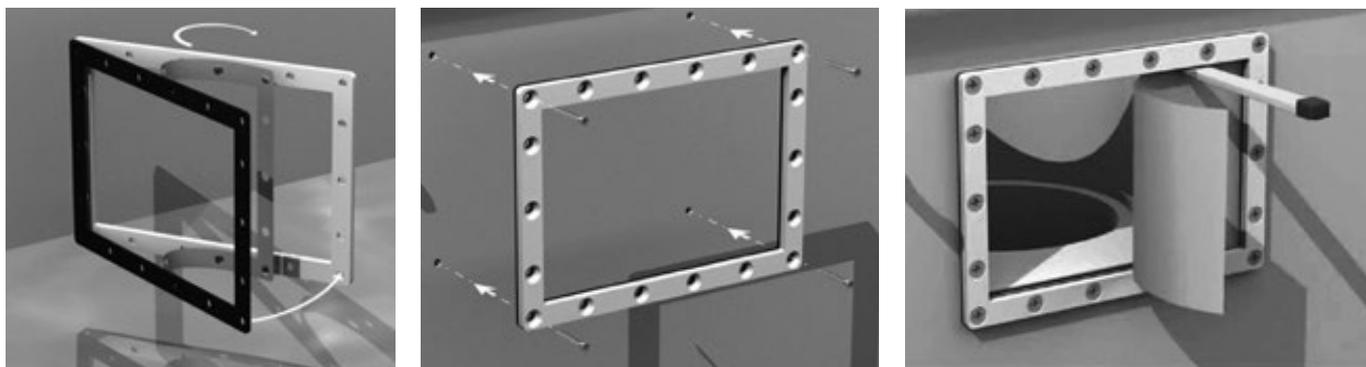
Figura 37 – Instalación de la brida del skimmer
